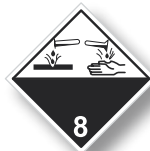
N°8 Matière corrosive
